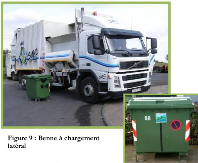
Figure 9 : Benne à chargement latéral
