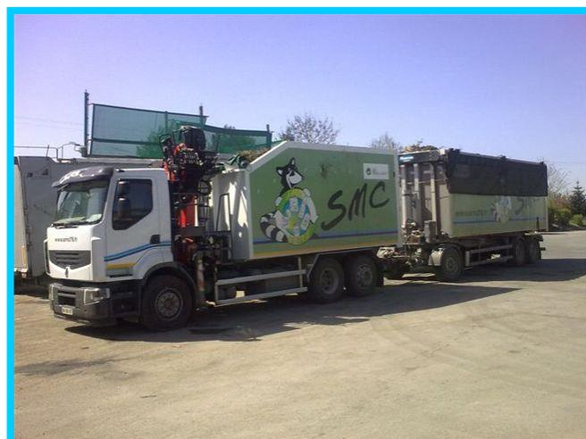
Figure 12 : Porteur grue avec remorque bennante
